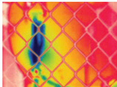
Passive Autofokussysteme erfassen manchmal nur Objekte im Nahfeld.
