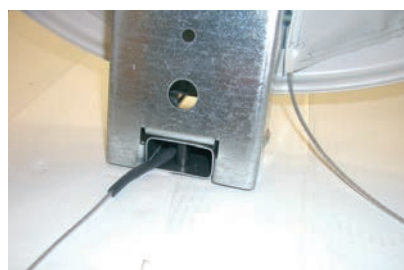
Heizleiter zur Beheizung des Empfängerarms
