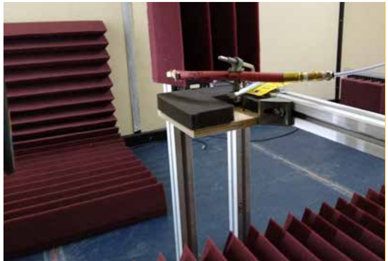
Abbildung 3: Die Art des Lecks am Schlauchs wird in einem Winkel von 30 Grad gemessen.
