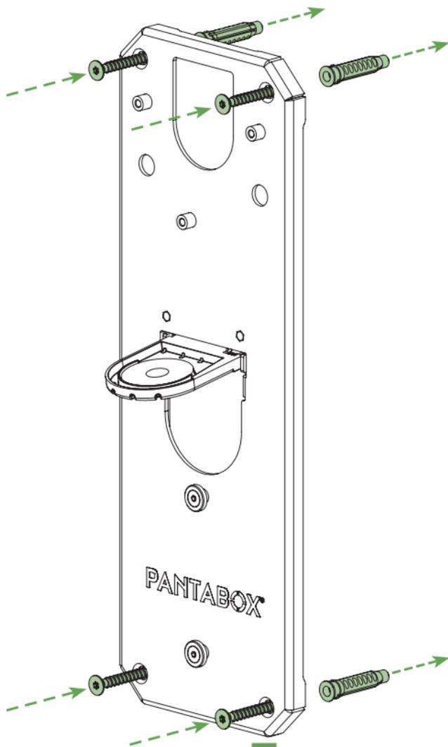
Min. 100 cm über dem Boden montieren.
