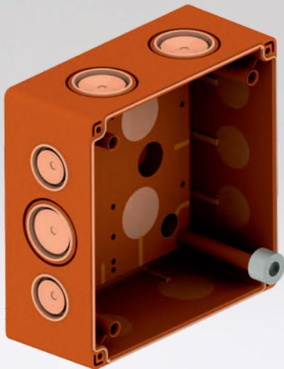
Die Abzweigdosen mit Funktionserhalt bestehen aus halogenfreiem Material. Im Brandfall sichern sie bis zu 90 Minuten die Stromversorgung. Somit gewährleisten sie unter anderem die Funktionalität des Notausstoßes, der Fluchtwegbeleuchtung oder der Brandschutztüren. Diese Dosen kommen insbesondere in Gesundheitseinrichtungen, Einkaufszentren, Parkplätzen oder Produktionshallen zum Einsatz.
