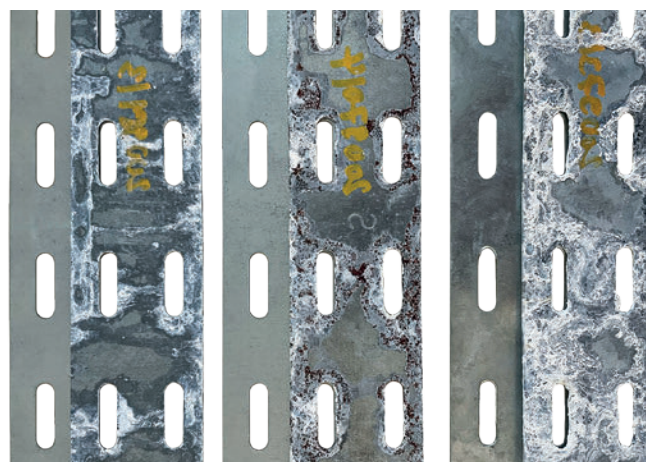
ZM - kontinuierliche Verzinkung mit Magnesium und Aluminiumbeimischung
