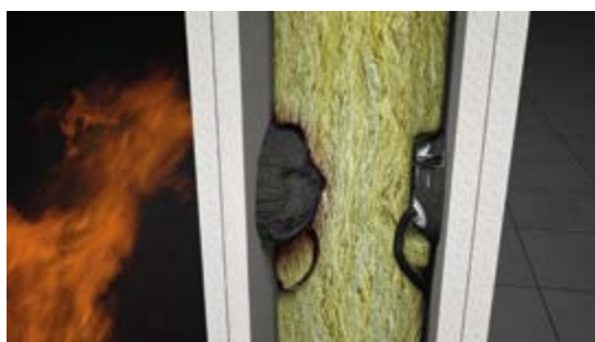
Darstellung der Reaktion des Dämmschichtbildners im Brandfall.
