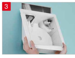
Der praktische Vorwandadapter ELS-VA wird nun montiert. Abluftleitung und Netzleitung werden am ELS-Gehäuse angeschlossen. Anschließend wird das Gehäuse einfach eingeschoben. Der mitgelieferte Putzdeckel schützt vor Verschmutzung.
