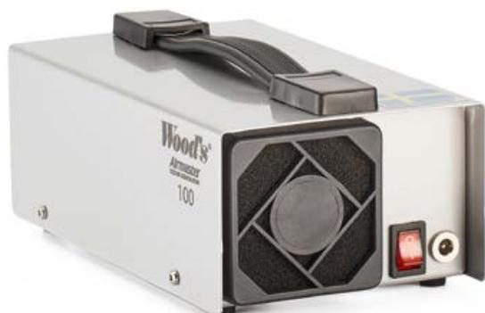
Der kompakteste Ozongenerator im Wood's Sortiment ist außerdem mit einem Vorfilter ausgestattet, der das Ozongerät schützt. Sowohl Vorfilter als auch Keramikplatte sind Verschleißteile, die abhängig von der Häufigkeit der Nutzung ca. alle 6 bis 12 Monate getauscht werden sollten.
