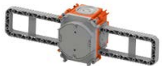
Beispiel für die direkte Befestigung einer Gerätedose an der Bewehrung mit Hilfe der Montageflügel
